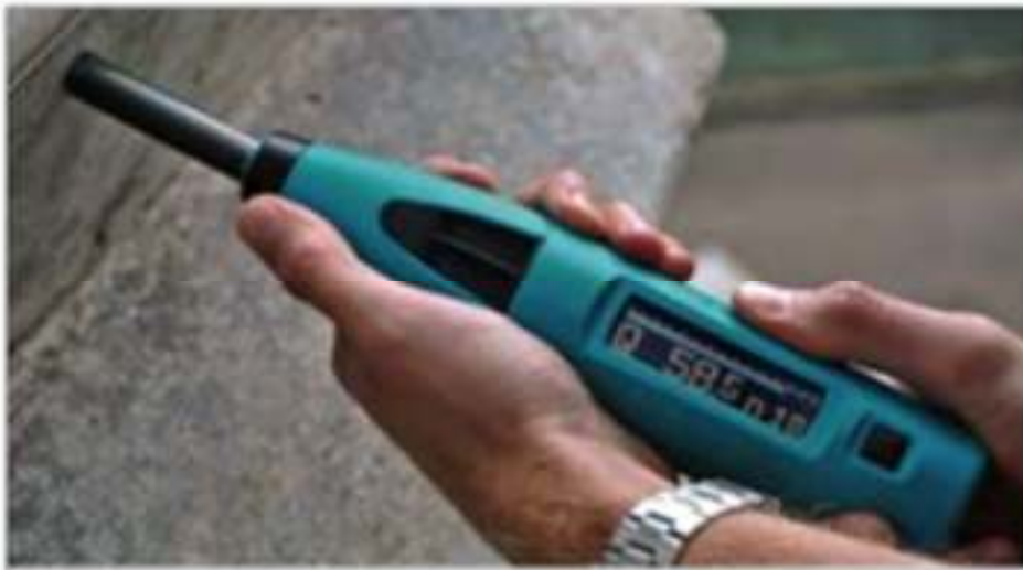
Gambar.E.2. Ilustrasi Pemeriksaan menggunakan Rebound Test Hammer / Concrete Test Hammer/ Palu Beton
